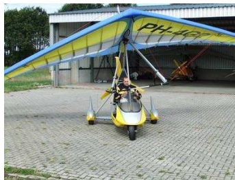
Micro Light Airplane (MLA): driewielig luchtvaartuig, motor en propeller aan voertuig, vaste bestuurbare vleugel, rijdende start. Hier ter vergelijking weergegeven maar zijn niet aangevraagd
