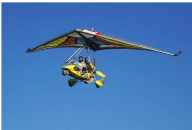
Micro Light Airplane (MLA): driewielig luchtvaartuig, motor en propeller aan voertuig, vaste bestuurbare vleugel, rijdende start. Hier ter vergelijking weergegeven maar zijn niet aangevraagd
