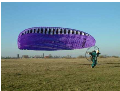
Paramotorvlieger (ook wel schermvliegen): motor en propeller op de rug, parachute, lopende start
