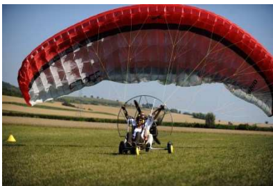
Trike: driewielig luchtvaartuig, motor en propeller aan voertuig, parachute, rijdende start
