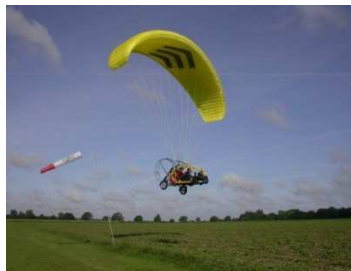
Trike: driewielig luchtvaartuig, motor en propeller aan voertuig, parachute, rijdende start
