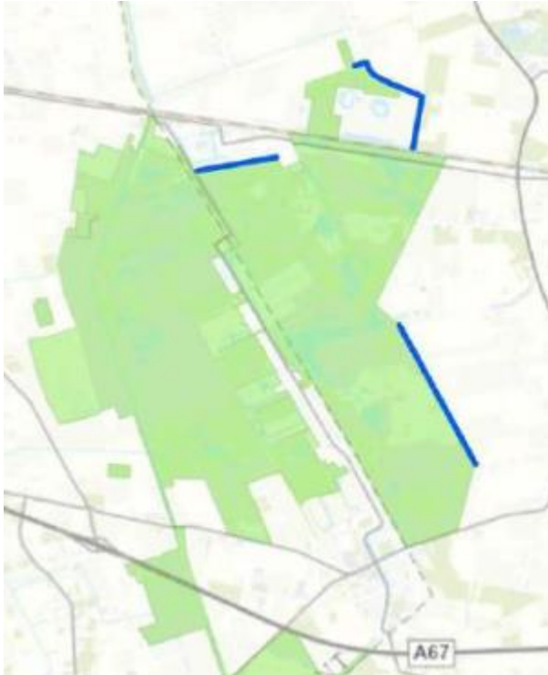
Figuur 3-25 Aangebrachte damwanden (kwelschermen) (Bron: Stuurman et al., 2021)
